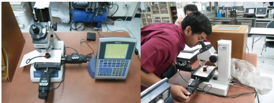
ภาพที่ 9 แสดงการตรวจสอบขนาดชิ้นงานยางเปรียบเทียบกับการออกแบบ
