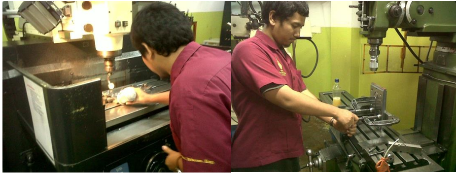
ภาพที่ 5 แสดงการสร้างแม่พิมพ์สำหรับขึ้นรูปยาง
