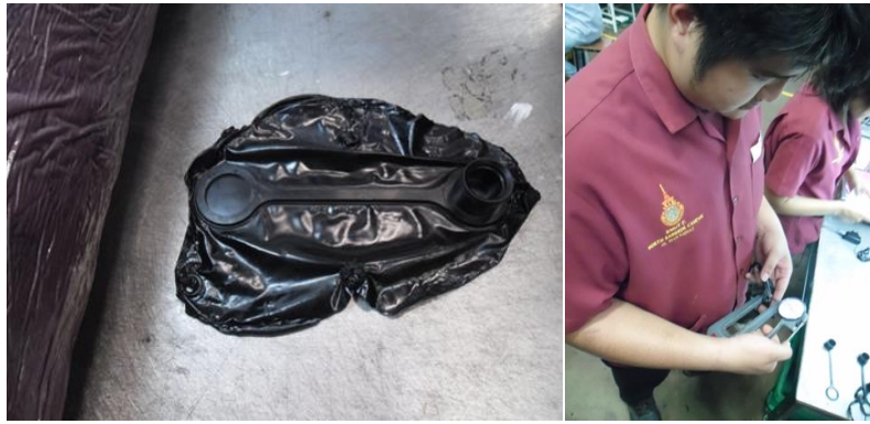
ภาพที่ 8 แสดงการตรวจสอบชิ้นงานยางหลังขึ้นรูป
