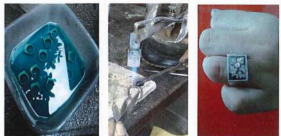
รูปที่ 3 การกัดกรวดลวดลายและการลงยาเงินบนตัวเรือน
